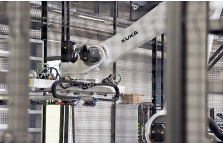
Der Roboter pufft die Teile und gibt sie sortiert an die Bohranlage weiter.
