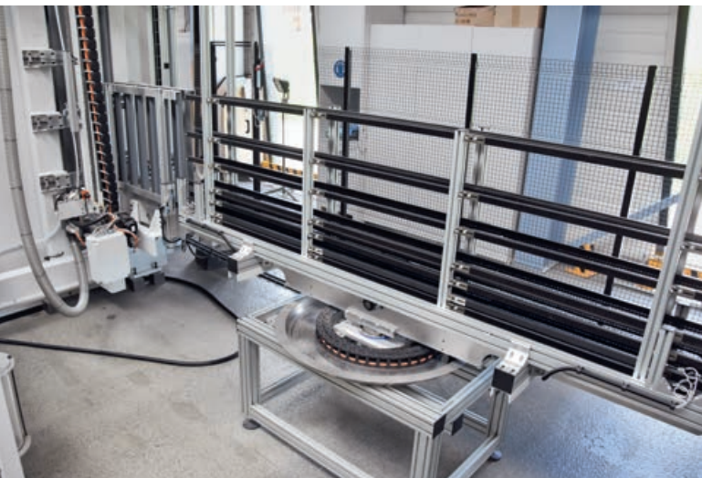
Vor den Bohranlagen befindet sich je eine Wendevorrichtung für die beidseitige Bearbeitung.
