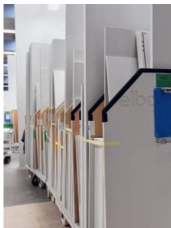
Die fertigen Teile werden über ein Igelmagazin ausgegeben und in die Kommissionierwagen gestellt.
